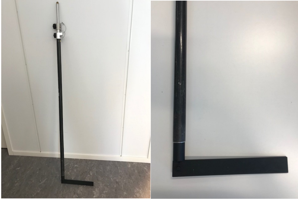
Kuva 10. Prismasauva, jossa on kiinni kaivolatta
