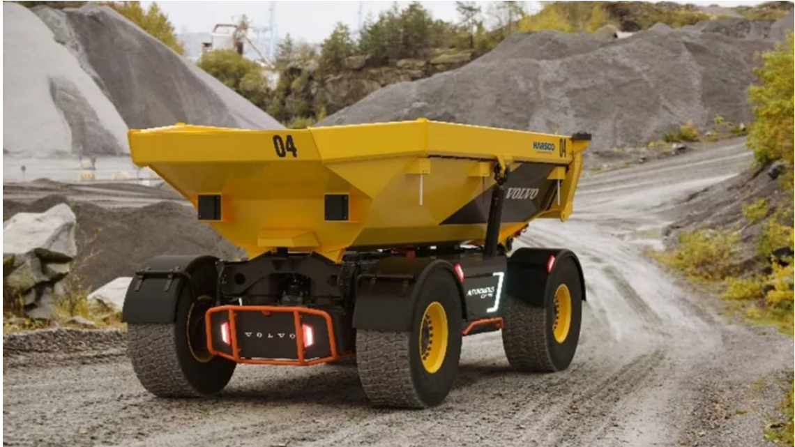
Kuva 3. Volvo Tara, pilottivaiheessa oleva autonominen dumper [5]
