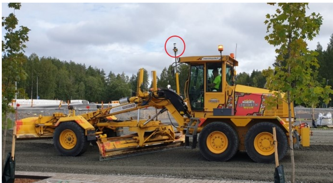
Kuva 5. Aktiiviprismalla varustettu tiehöylä ( https://www.maansiirtopuuha.fi/kalusto/muu-kalusto/item/11-tiehoeylae )
