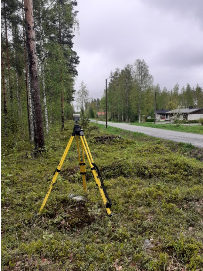
Kuva 18. GNSS-vastaanotin tarkistuspisteen päällä
