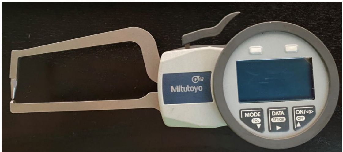
Kuva 25. Kuorintojen mittaukseen käytettävä pikamittakello.
