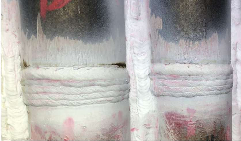
Kuva 31. Esimerkki jouheasta liittymästä ja maltillisesta pinnoitushitsin kuvusta.
