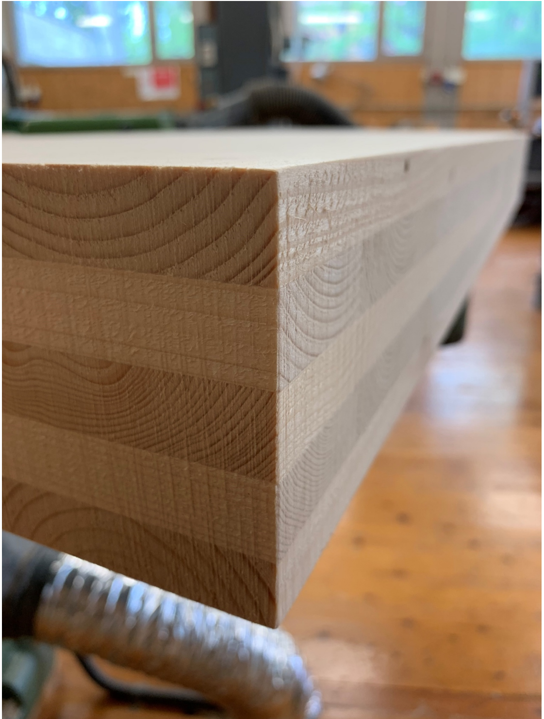
Kuva 17. Käytetystä puusta valmistettu CLT-proto (Stenstad 2022)
