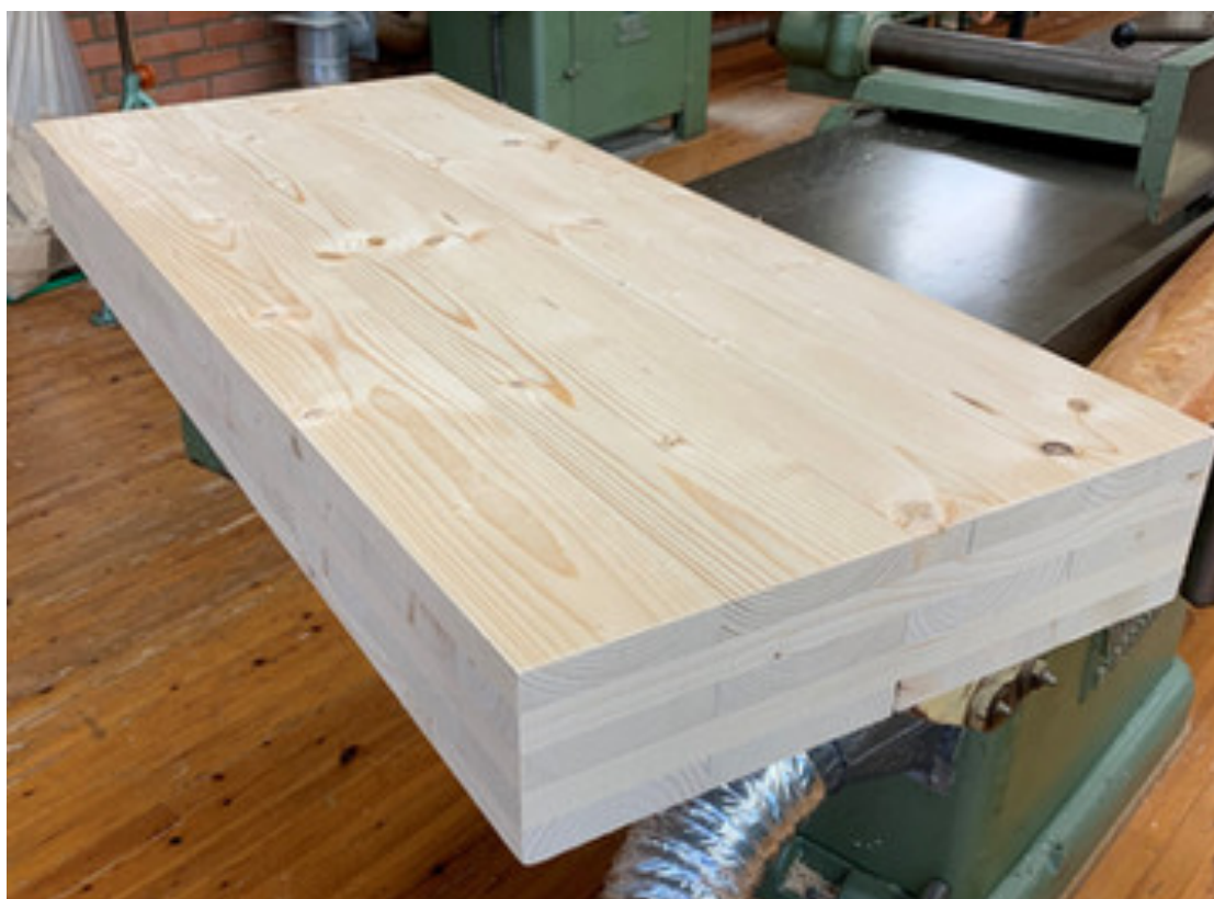
Kuva 16. Käytetystä puusta valmistettu CLT-prototyyppi (Stenstad 2022)
