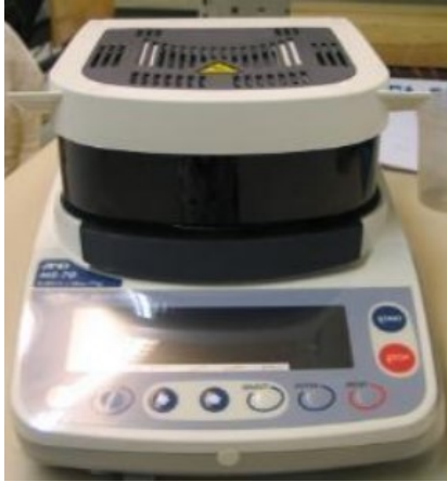
Kuva 8. Kosteusanalyssaattori A&D MS-70
