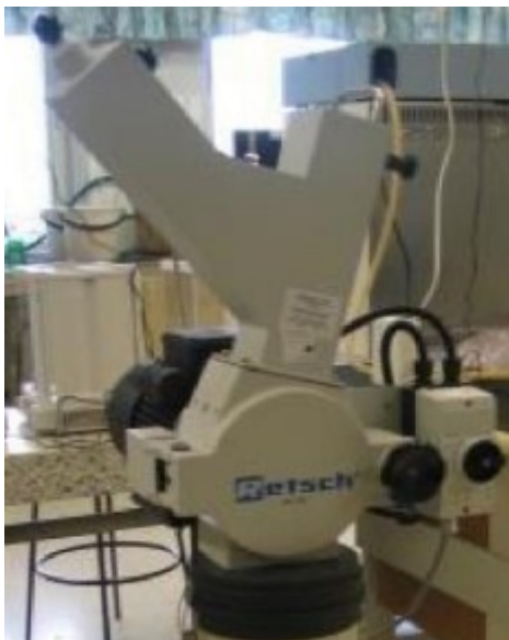
Kuva 9. Leikkaava mylly Retsch SM100
