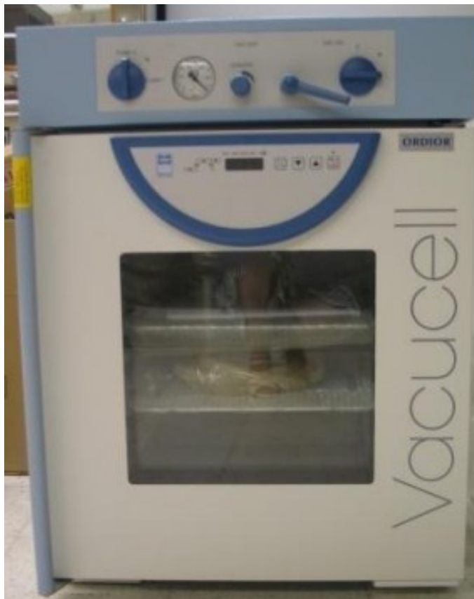
Kuva 2. Vacucell 55 kuivausuuni (vakuumi)
