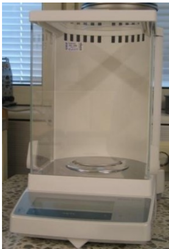
Kuva 5. Analyysivaaka Mettler-Toledo AB 104-S/PH
