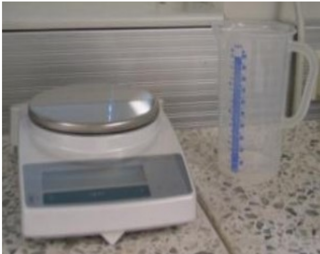
Kuva 4. Yläkuppivaaka PB-3002-S/PH Mettler-Toledo
