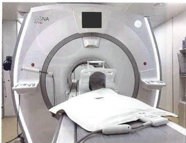
Kuvauspöydän etualalle on aseteltu peittokela, pääkela on paikallaan taaempänä. Itse magneettilaitetta reunustaa led-valot, joka luo aikansa mukaista tunnelmaa kuvaushuoneeseen.
