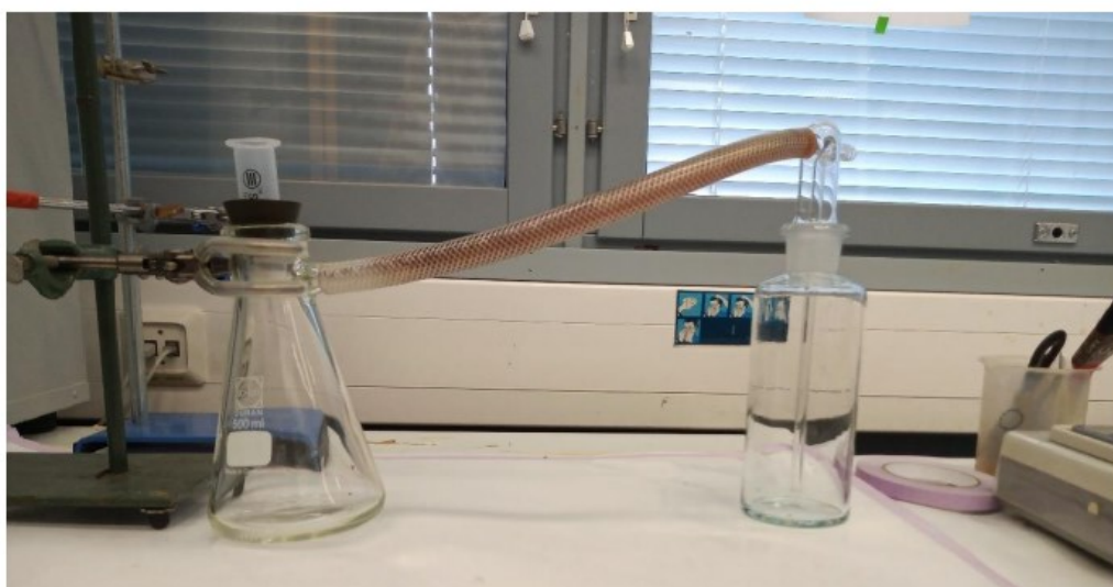
KUVA 2. SPE-laitteisto, jossa kaasunpesupullo estämässä nesteen päätymistä imupulloon
