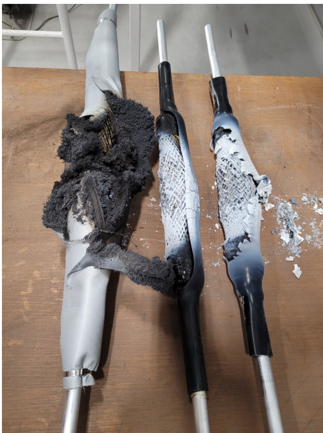
Kuva 31. Testatut tuotteet savun tiheyden jälkeen. Vasemmalla hybridijatkos suojattuna palonsuojakangalla, hybridijatkos ja kylmäkutistejatkos.
