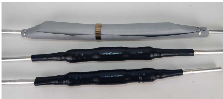
Kuva 28. Savun tiheyden mittausta varten metallitangolle asennetut jatkokset. Ylimpänä hybridi + palonsuojakangas, keskellä lämpökutistejatkos ja alimpana kylmäkutistejatkos.
