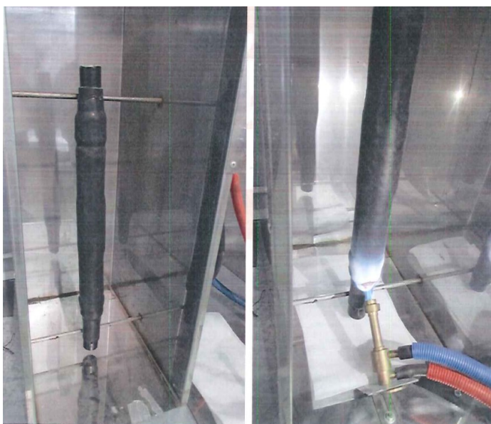
Kuva 6. Venäjällä käytetty tapa testata jatkos yksittäispoltolla [14]. Jatkos on asennettu PE-ulkovaippaisen kaapelin päälle. Testiasettelu vastaa muuten yksittäispoltton testiasettelua.
