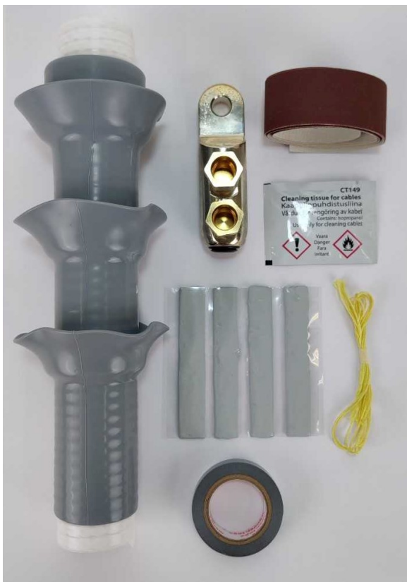
Kuva 22. Kylmäkutistepäätepakkauksen komponentit kylmäkutistettava päätteletku, momenttiruuvikaapelikengät, tiivistysmassa, PVC-teippiä sekä asennukseen puhdistuspyyhe ja hiomapaperia. Lisäksi pakkaukseen kuuluu silikonirasva.
