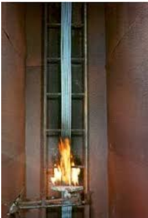
Kuva 11. Käynnissä oleva nippupoltto, jossa näkyy kaapelien asettelu tikkaissa takaseinälle testin aikana ja testiliekkin kohta [20]. Tikkaiden pituus on 3,5 m ja leveys 0,5 m.
