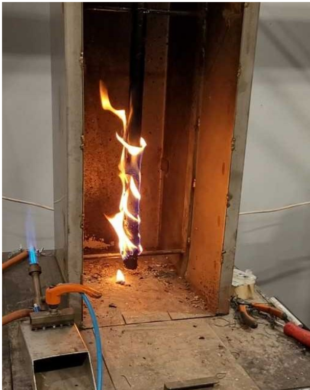
Kuva 26. Referenssikaapelin yksittäispoltossa kaapeli paloi kokonaan.
