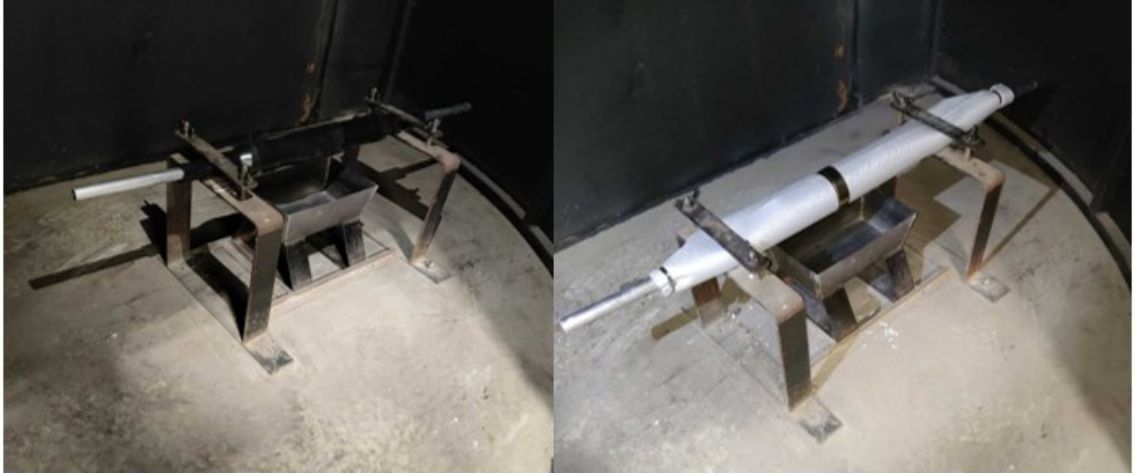
Kuva 29. Savun tiheyden testiasettelu. Vasemmalla puolella hybridijatkos ja oikealla hybridijatkos suojattuna palonsuojakankaalla.
