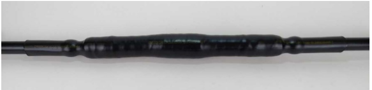
Kuva 16. Lämpökutistejatkos asennettuna referenssikaapelille.
