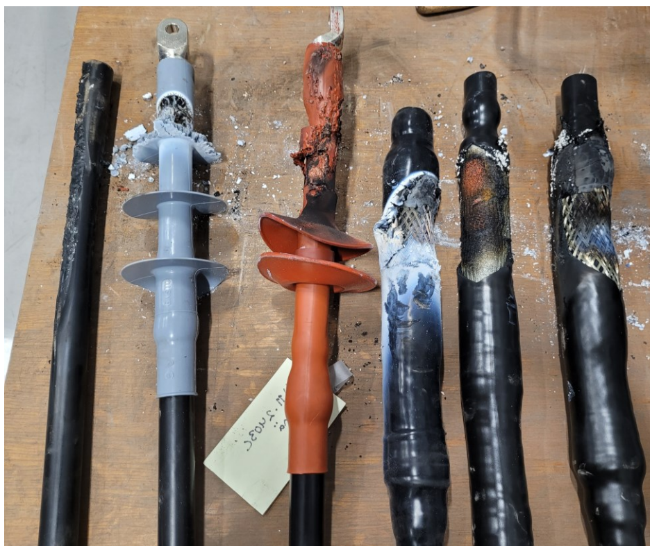
Kuva 30. Vasemmalta alkaen referenssikaapeli, kylmäkutistepääte, lämpökutistepääte, kylmäkutistejatkos, lämpökutistejatkos ja hybridijatkos yksittäispoltton jälkeen.
