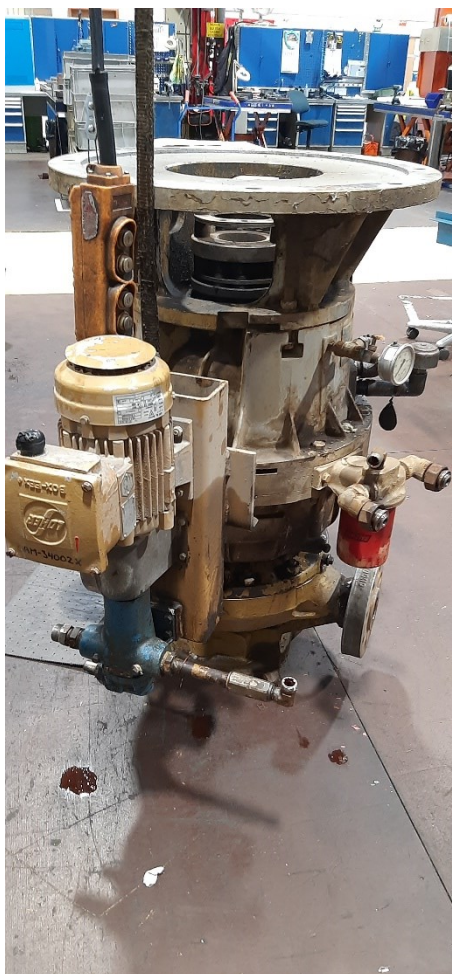
Kuva 12. Sundryne-pumppu erillisellä vaihteiston öljypumpulla.
