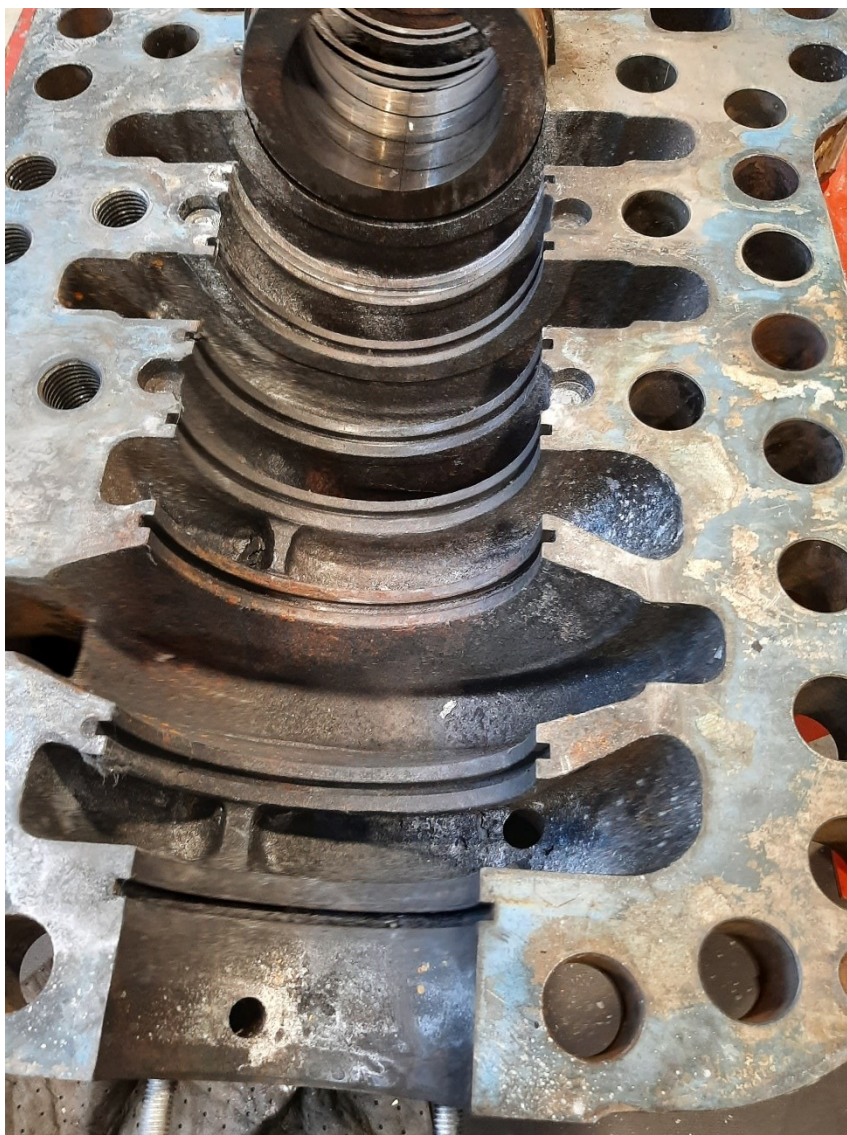
Kuva 15. GA-9101S staattorin kanavat lohkon valussa.
