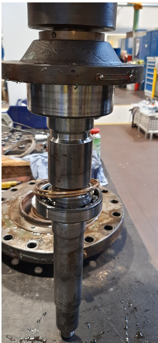
Kuva 9. Messinkiset heittorenkaat akselilla.
