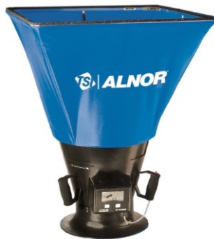
Kuva 2. Balometri 610 mm X 610 mm:n hupulla (TEKNOCALOR).
