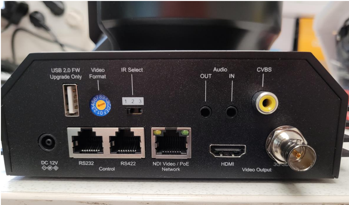
KUVA 1. Erään 3G-SDI-videokameran liitäntäpaneeli
