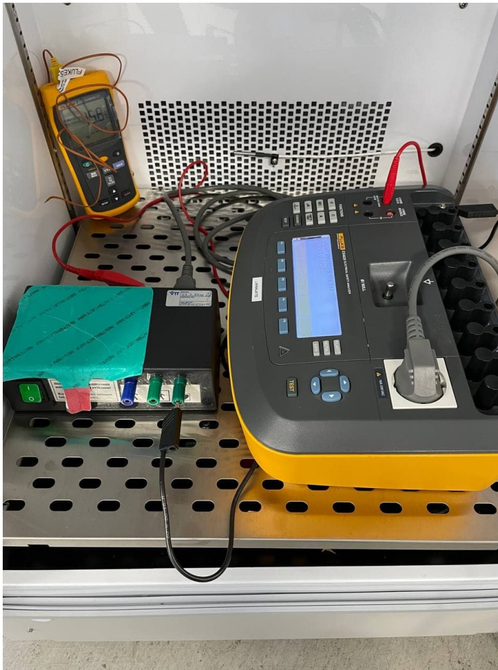
Kuva 11. CF-tyyppin potilasliityntäosan vuotovirran mittausasetelma.
