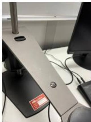
Kuva 4. Videomikroskoopin varsi ja lukitusvipu (musta)
