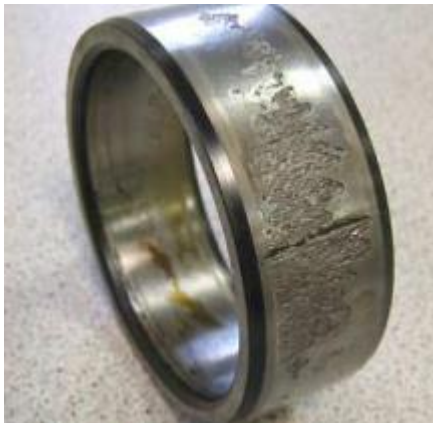
Kuva 19. Väsymisestä aiheutuneet halkeamat.
