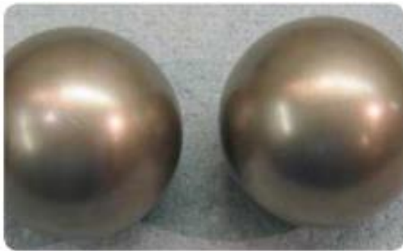
Kuva 13. Nokeentuneet laakerin kuulat.
