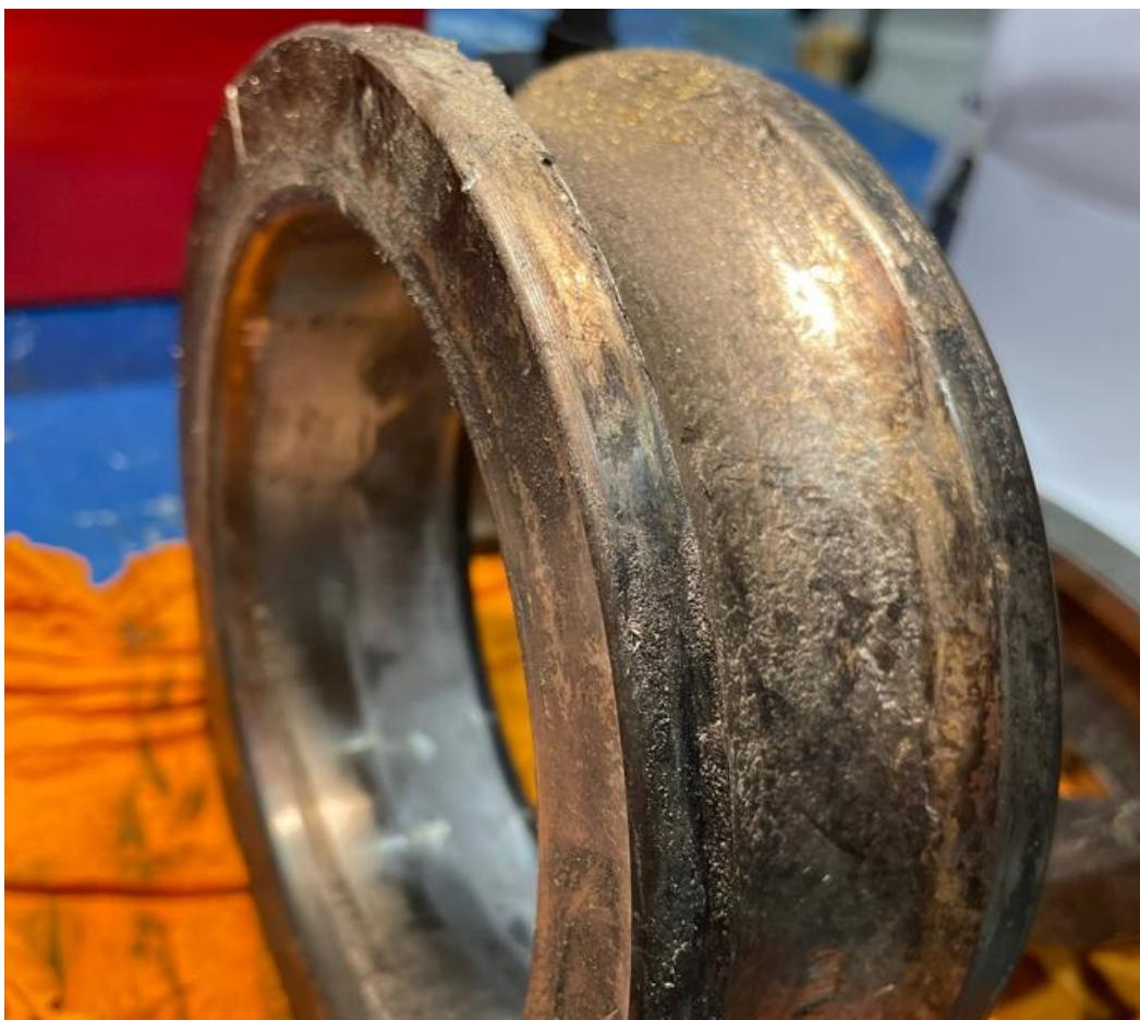
Kuva 22. Tapauksen täysin vaurioitunut laakerin sisärengas.
