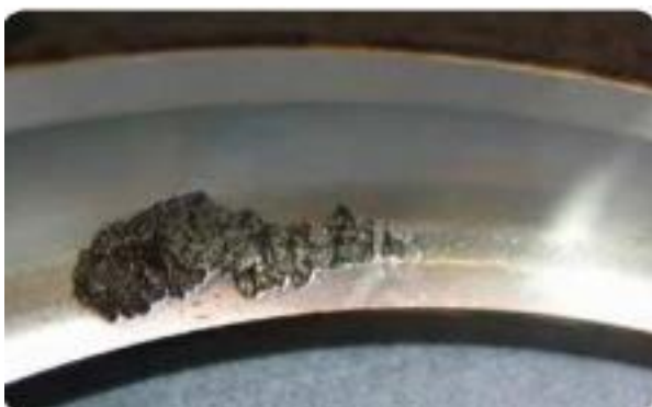
Kuva 5. Pinnan sisäpuolelta purkautunut halkeama.
