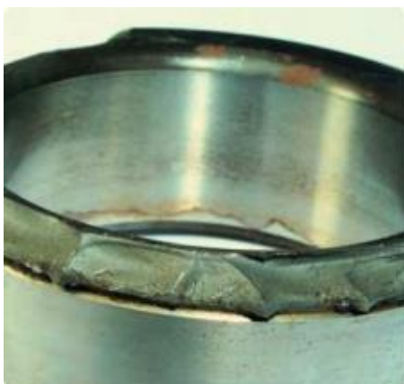
Kuva 18. Väkivaltaisen käsittelyn aiheuttamat murtumat.
