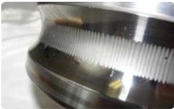
Kuva 14. Washboarding -kuvio laakerin kehällä.
