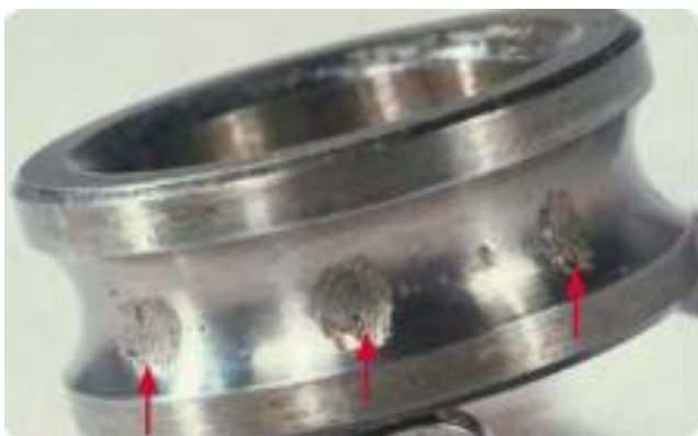
Kuva 15. Ylikuormituksesta aiheutuneet painaumat.
