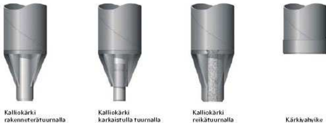
KUVA 8. Suuriläpimittaisten RR-paalujen paalukärkityypit (Suuriläpimittaiset teräsputkipaalut pohjarakentamisessa 2010, 7)
