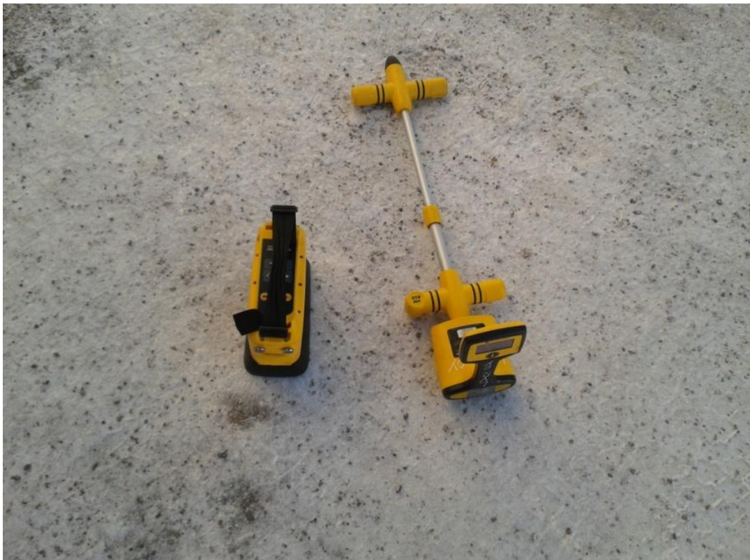
KUVA 5. Kaapelitutka Metrotech VM-810
