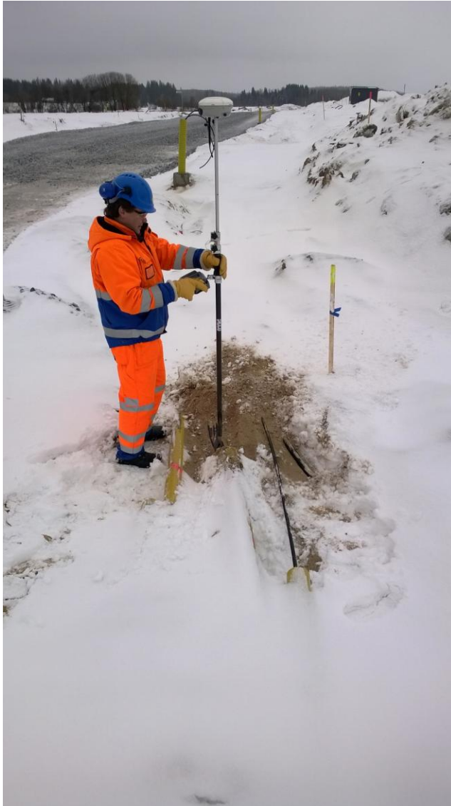
KUVA 3. Kartointu Trimble R8 -GPS/GNSS-laitteella
