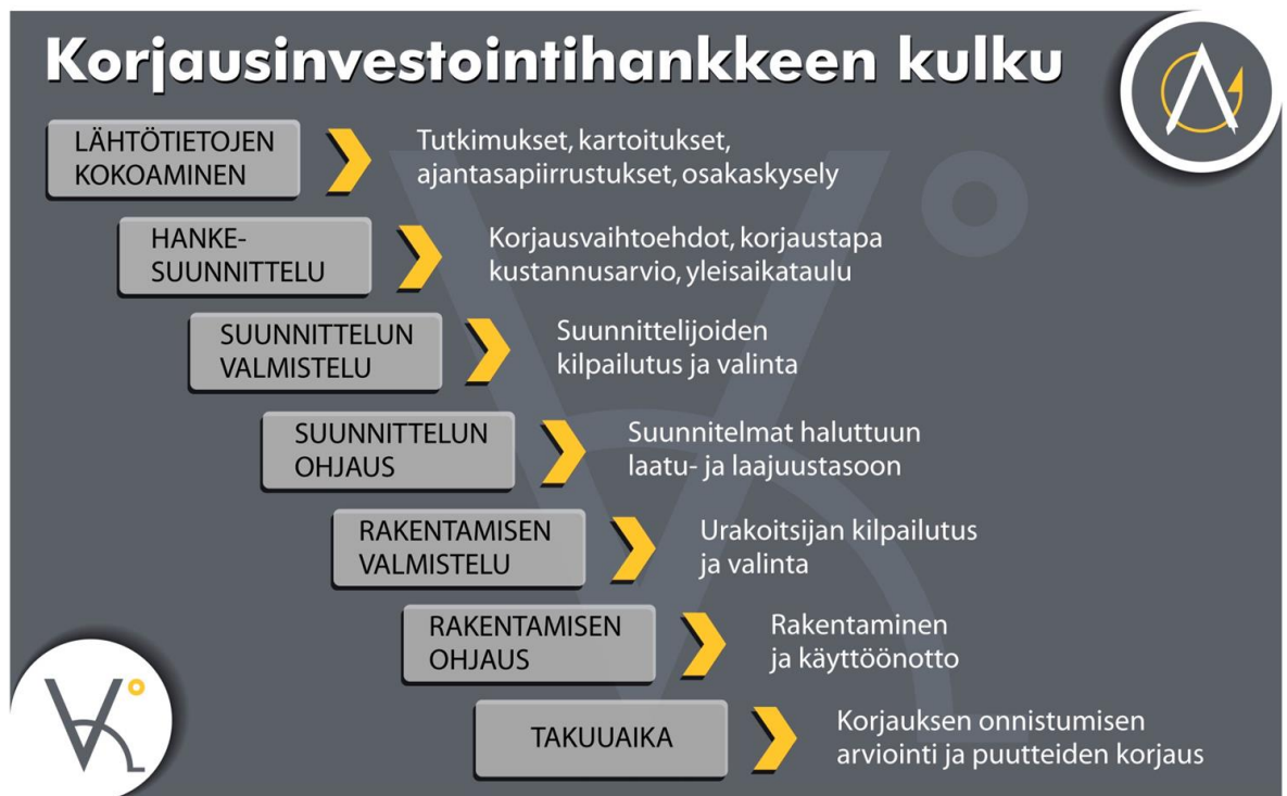
Kuva 4. Korjaushankkeen kulku kuvana (Rakennuttajatoimisto Valvontakonsultit Oy).
