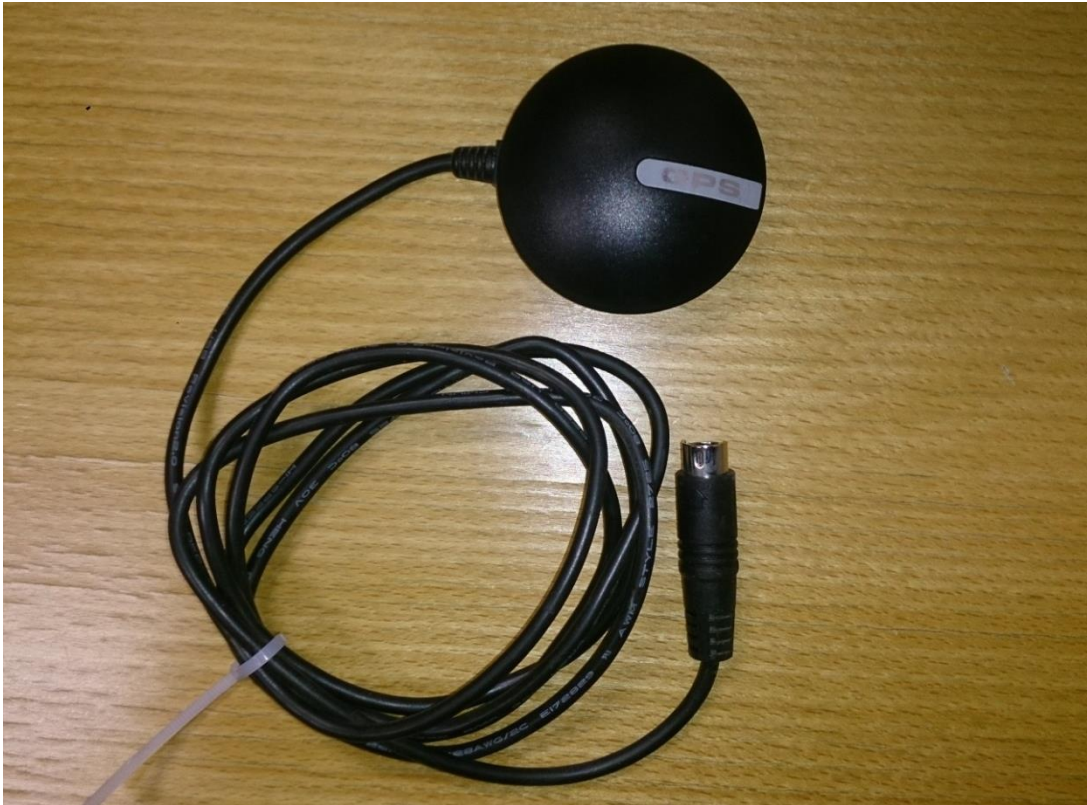
KUVA 16. Taksipäätteeseen yhdistettävä GPS-moduuli (kuva: Jukka Valkama)
