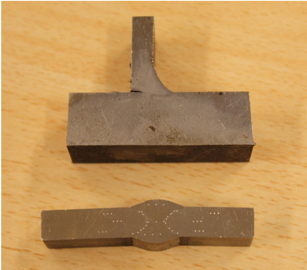
Kuva 4. Makrohieet T- ja päittäisliitoksesta.
