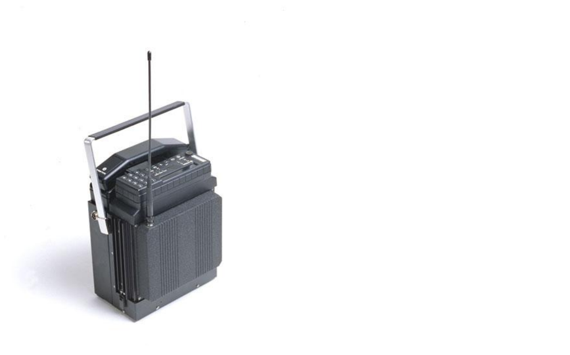
Figur 1. Nokias första mobiltelefon med NMT. Dock bara för användning i bilen. (Nawaz info, 2011)
