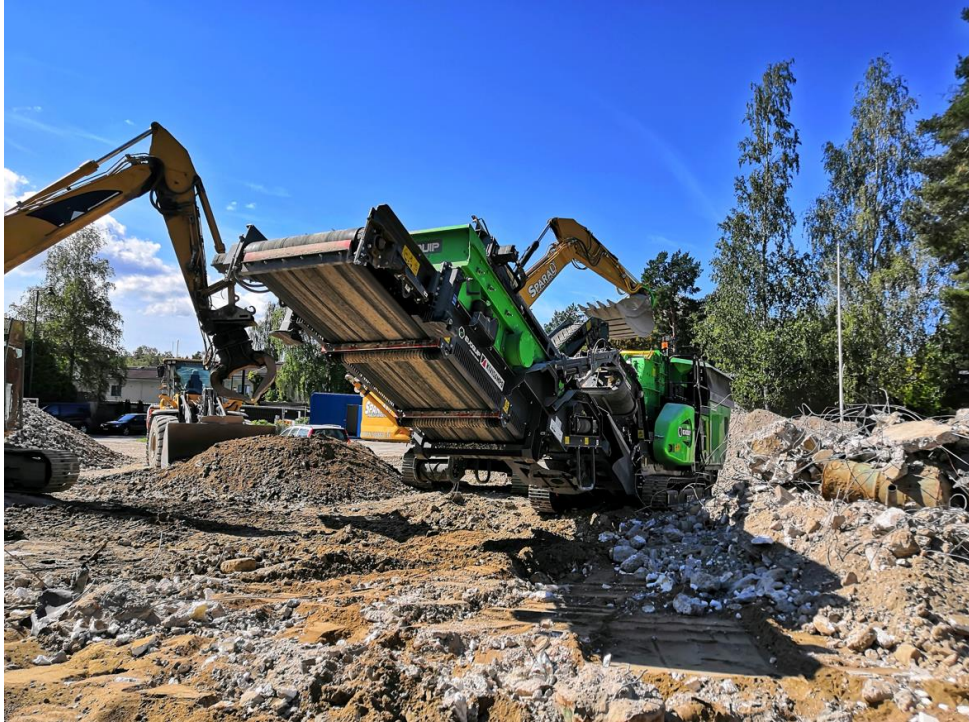
Kuva 10. Betonin murskaukseen käytetty iskupalkkimurskain.
