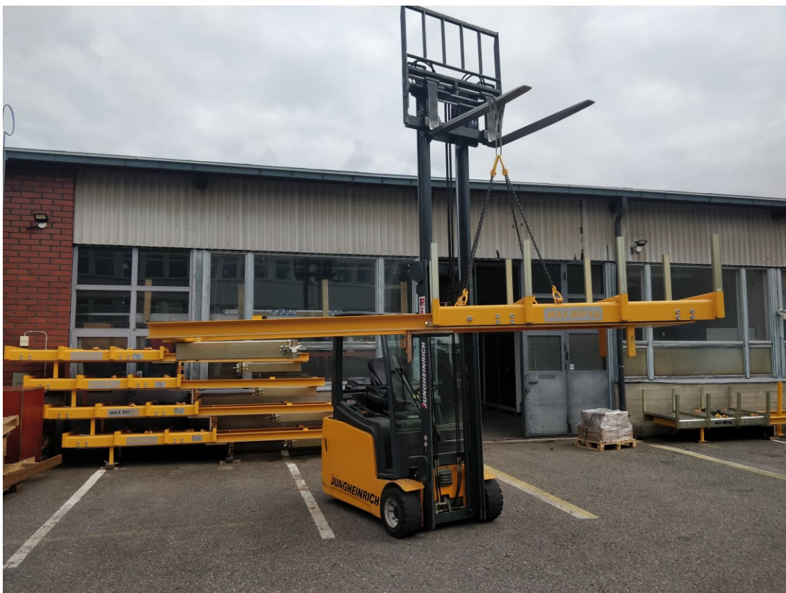
KUVA 18. Nostotaso nousee vaakatasossa kuljetusasennossa
