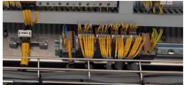
Kaapeli- ja johdinmerkintöjä ja riviliittin- ja riviinliittinrakentöjä raitiovaunussa
