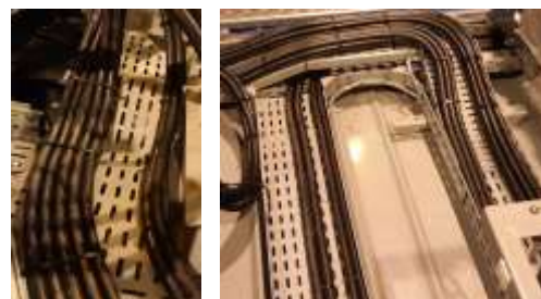
Kaapeleiden erottaminen raitiovaunun katolla
