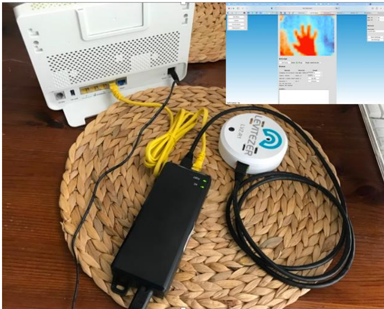
Kuva 10. LVZ-R1 kytkettynä WLAN-reitittimeen PoE-virtalähteen kautta.
