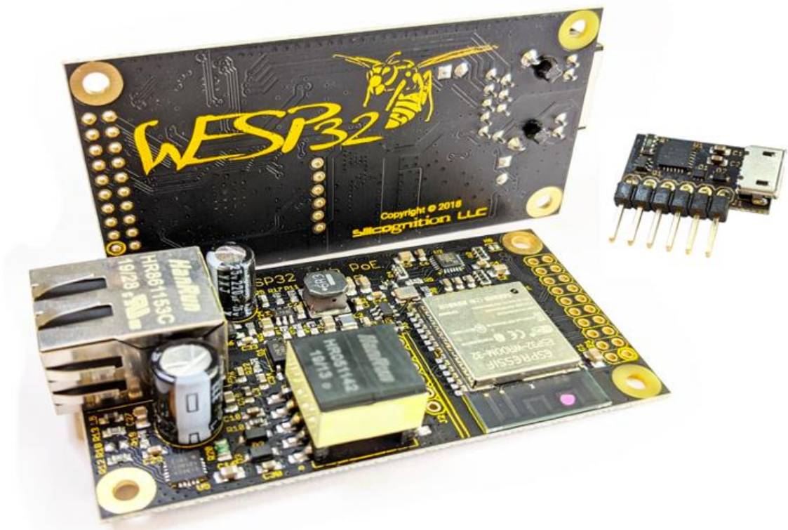
Kuva 9. wESP32-kehitysalusta ja wESP32-prog USB-alimoduuli.
