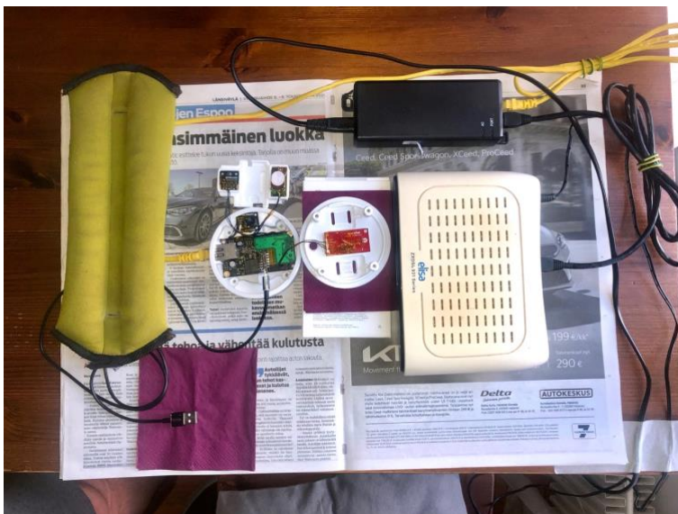
Kuva 11. LVZ-R1, PoE-virtalähde, WLAN-reititin, ja usb-kaapeli.
