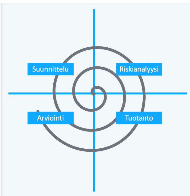
Kuvio 3. Selkeytetty versio spiraalimallista (muokattu Software Testing Help:in www-sivujen mallin pohjalta, n.d.)
