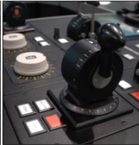
Bild 7.2 Styrbord akterliga poddspaken
