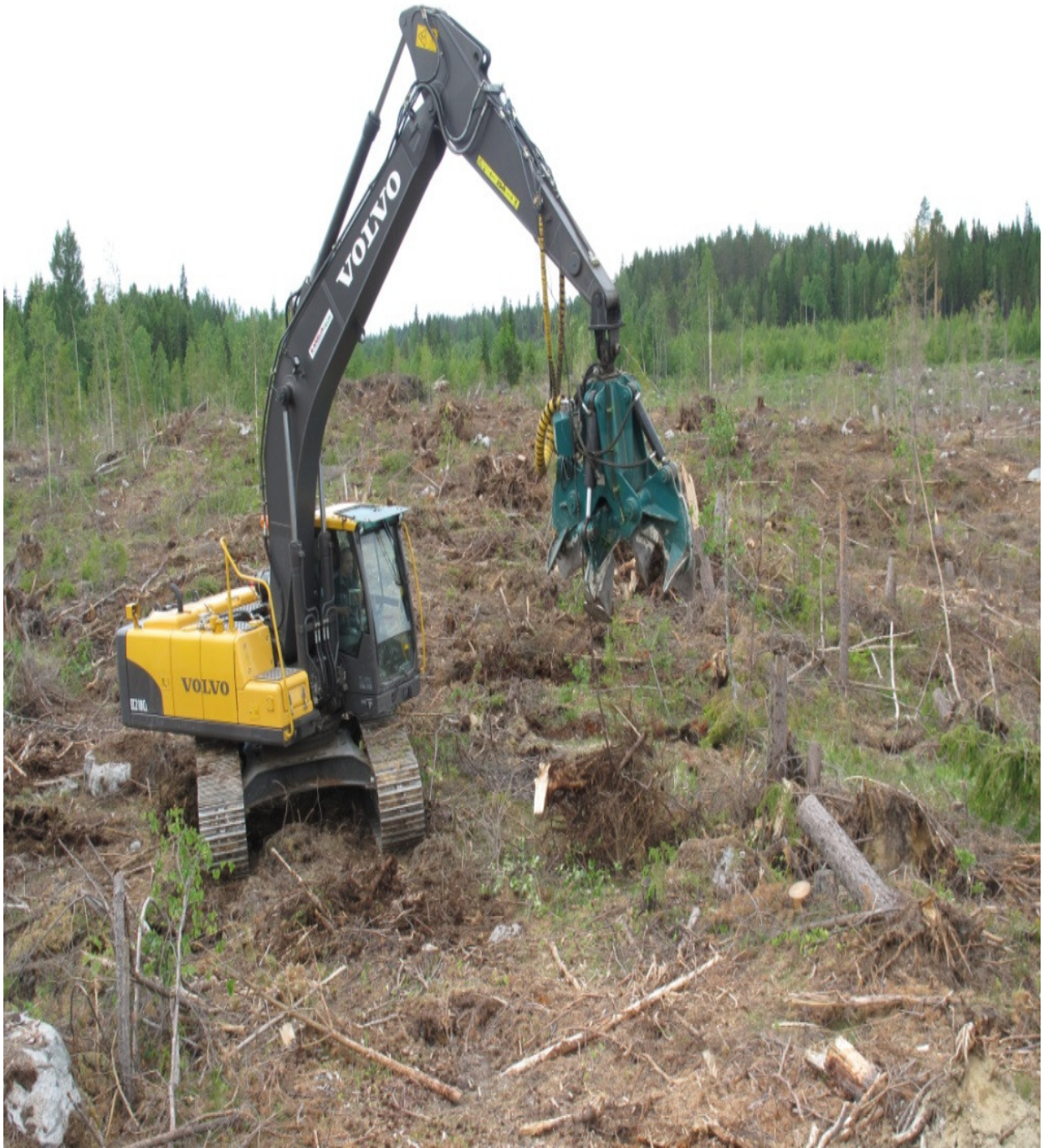
Kuva 1. Kannonnostokone Jokelan palstalla 16.6.2011.
