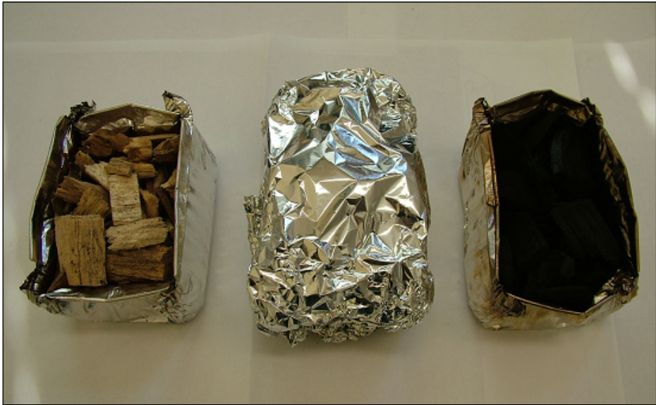
Kuva 3. Lämpökäsittelyuunissa torrefioitua haketta
