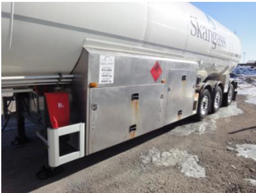
KUVA 15. Uuden kuljetussäiliön mittaristo- ja venttiilikaappi (Gasum).
