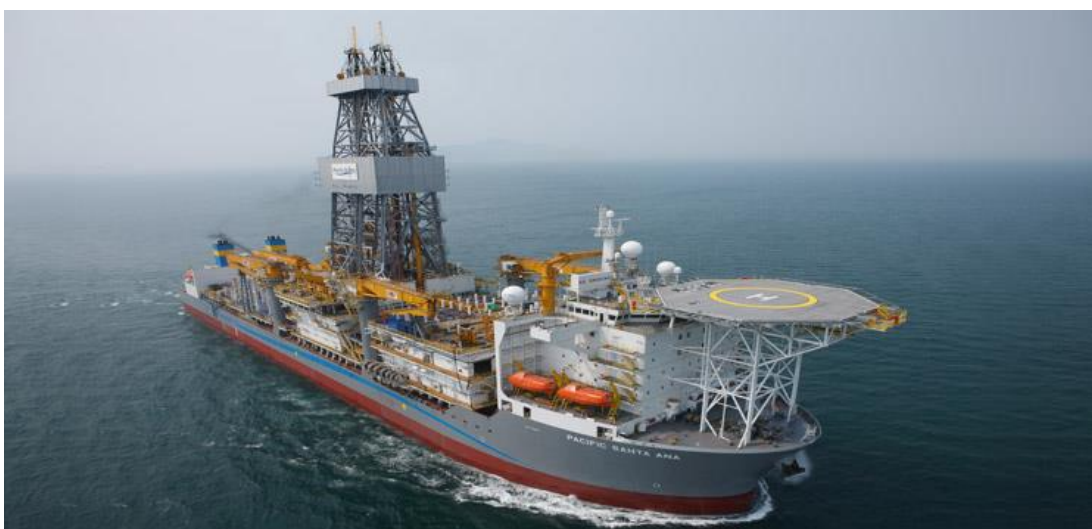
Kuva 8. Pacific Santa Ana operoi 3600 metrin syvyisessä vedessä ja poraa 12200 metrin syvyyteen asti (Pacific Drilling, 2011)
