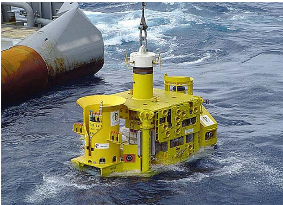
Kuva 15. Jakotukin asentaminen merenpohjaan (Offshore.no, 2013)
