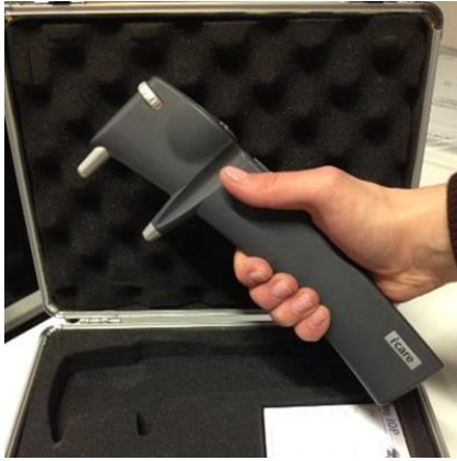
Kuvio 9. iCare®-kimmoketonometri (Jurvanen, Terhi 2013)
