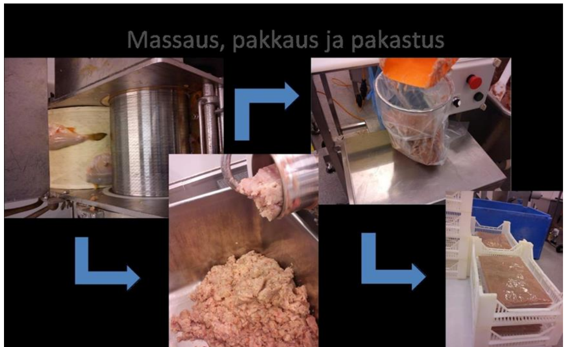
KUVA 1. Särkimassan valmistuksen työvaiheet. (Setälä ym. 2012, 47).
