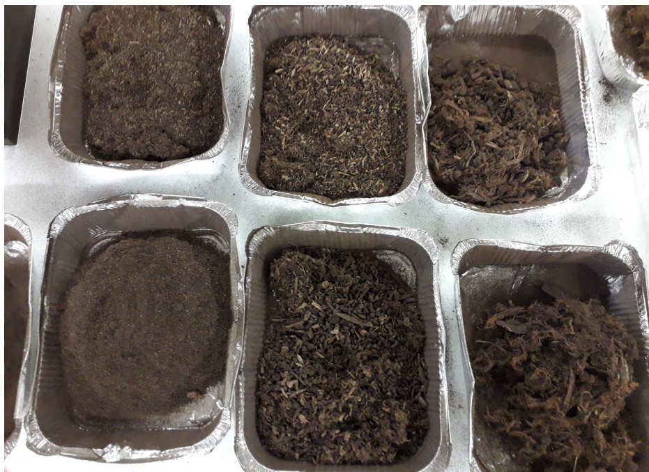
KUVA 1. Lantaturveseoksen eri seulajakeita (kuva Juha Vihavainen).
