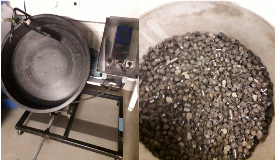
KUVA 2. Tuhkan rakeistukseen käytetty laitteisto sekä turvepelletti-tuhkaraeseos (kuva Juha Vihavainen).
