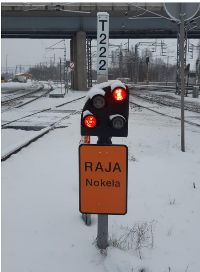
Kuva 10. Raideopastin Oulun ratapihalla, jossa punainen SEIS-opaste. Raideopastimella ohjataan junia liikennepaikoilla ja ratapihoilla.
