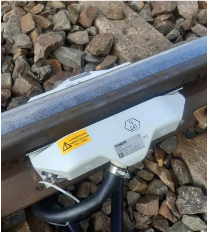
Kuva 11. Akselinlaskijan anturi kiinnitettynä ratakiskoon (Siemens) kuvattu TASE-projektilla kesällä 2021
