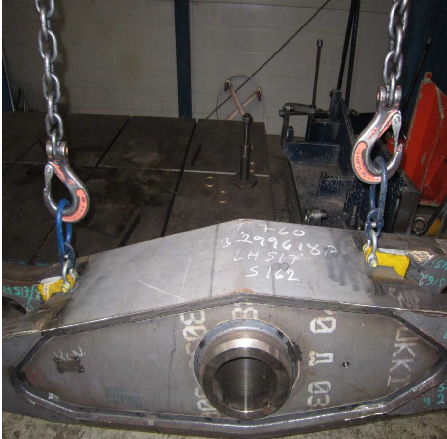
Kuva 18. Levykoukut kiinnitetty keinuvipuun
