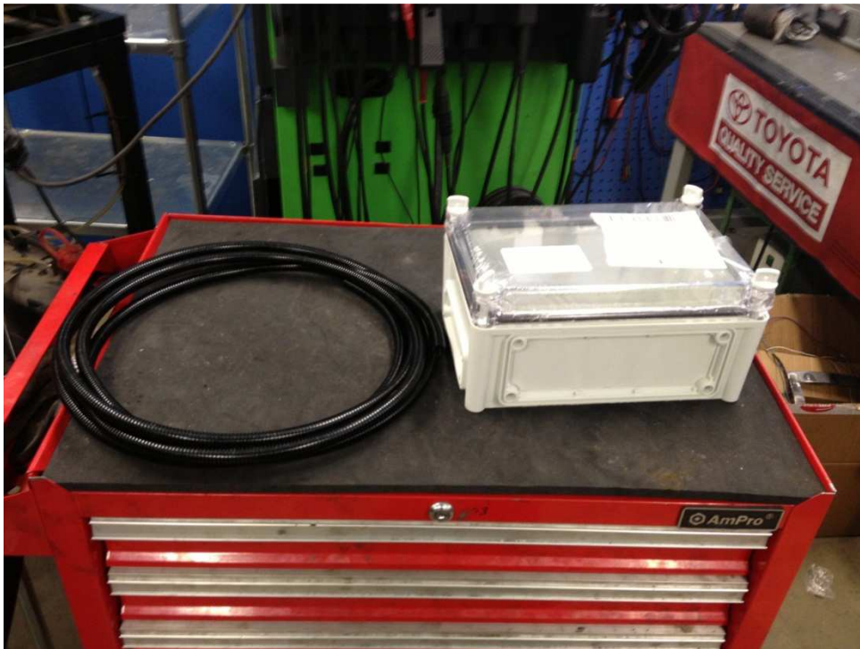
kuvio 13. Elektroniikan suojakotelo ja johtosarjan suojaputki.
