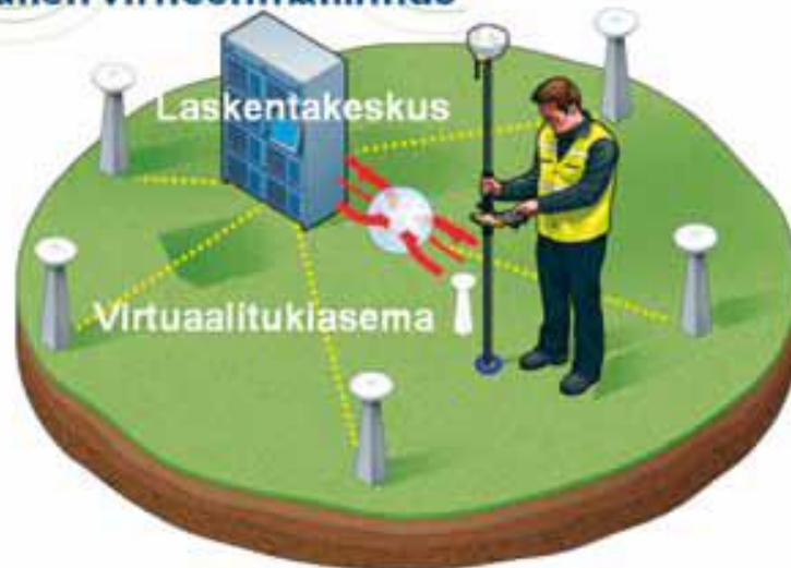
Kuva 12. VRS-järjestelmän toimintaperiaate /9, s.10/
