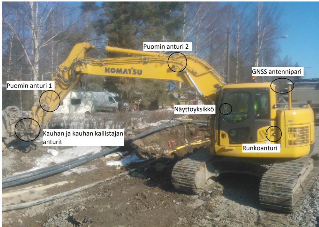
Kuva 4. Koneohjausjärjestelmän osien sijoittelu kaivinkoneeseen
