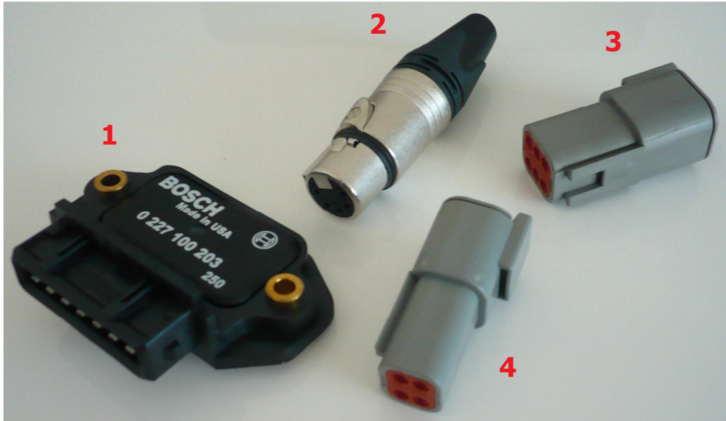
Kuva 8. Johtosarjaan käytettyjä tarvikkeita. 1) Boschin sytytysvahvistin, 2) XLR-kommunikointiliitin, 3) Deuschin 6-napainen DTM-liitin, 4) Deuschin 4-napainen DTM-liitin.
