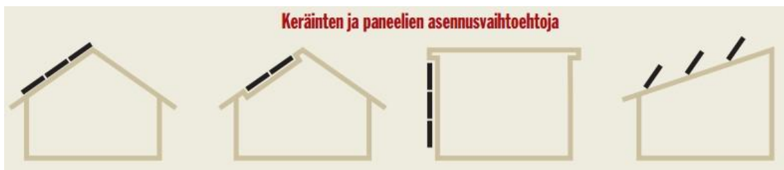
KUVA 7. Aurinkolämpökeräinten ja –paneelien asennusvaihtoehtoja (22)
