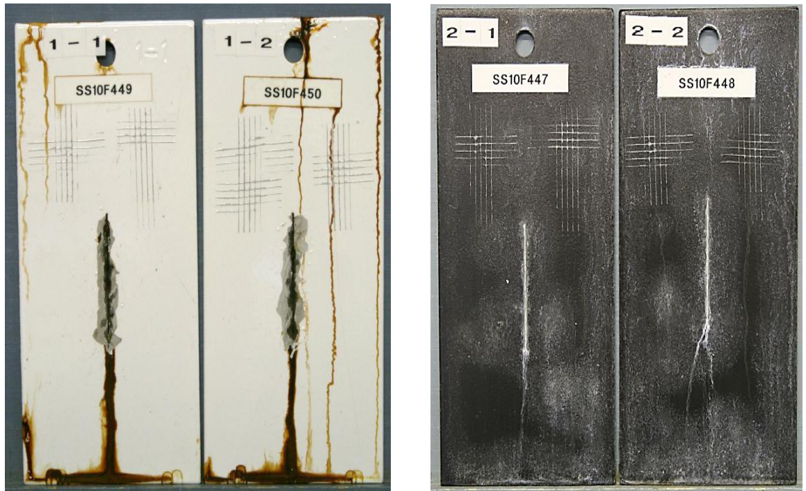
Kuvio 27. Koelevyt 1440 h. suolasumutestin jälkeen.
