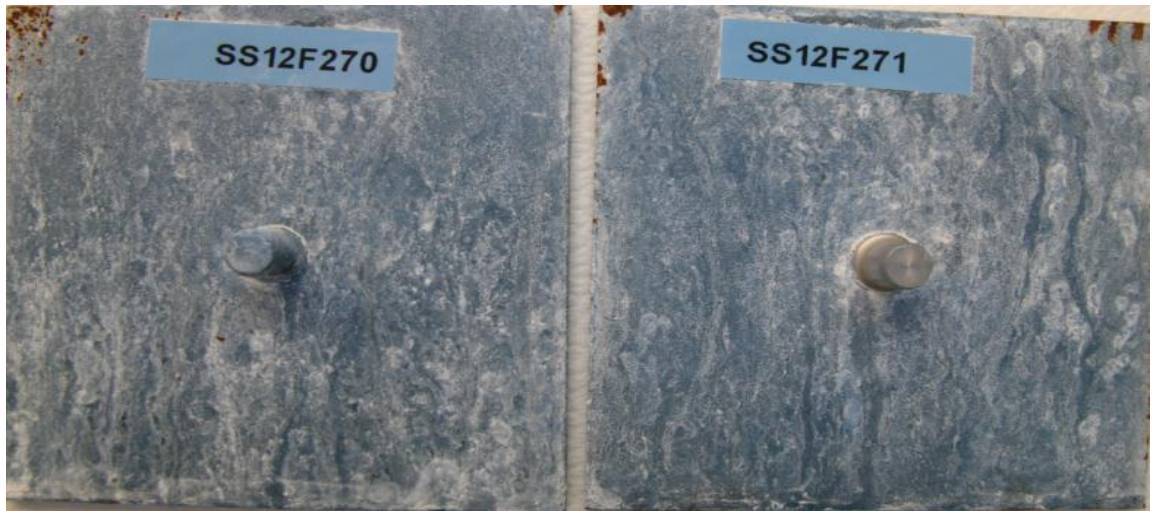
Kuvio 24. Suolasumukoestus 240 h jälkeen vastaa rasisusluokkaa C3-M.
