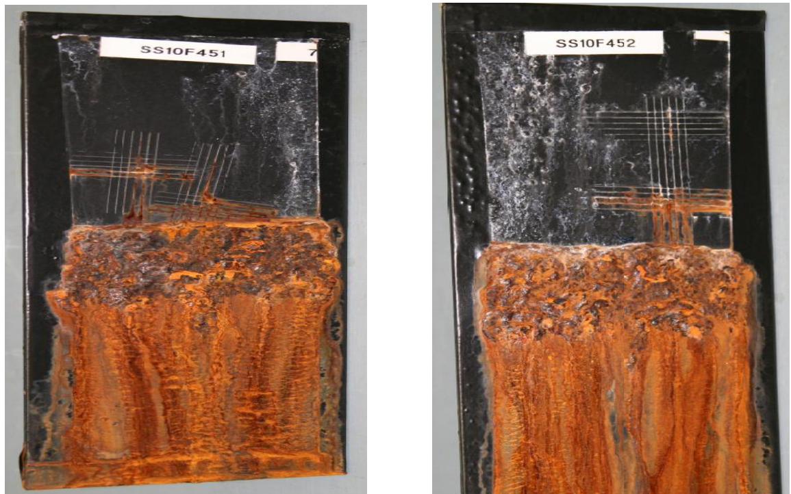
Kuvio 29. Koelevyt (SS10F451 ja SS10F452) 2880 h suolasumutestin jälkeen.
