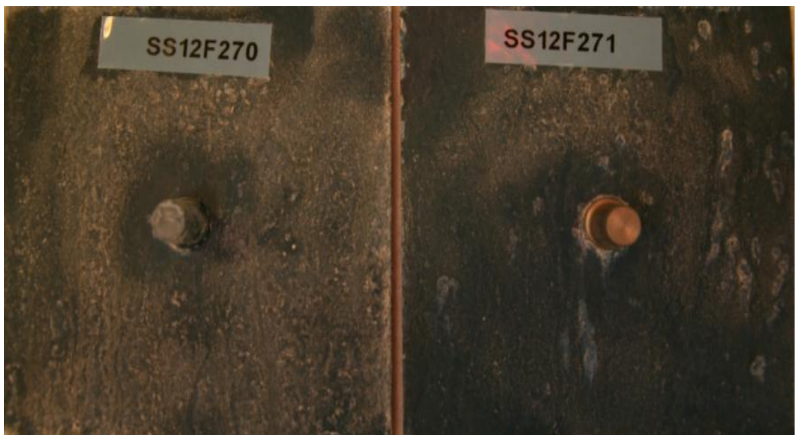
Kuvio 23. Suolasumukoestus 120 h jälkeen vastaa rasisusluokkaa C2-M.
