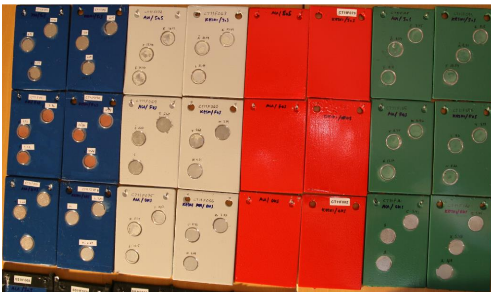
Kuva 13. Kondensaatiokaapissa olleita koelevyjä. Ylärivissä on SaS-käsitelyjä, keskimmäisessä Zn-fosfatoituja ja alarivissä silaanikäsiteltyjä koelevyjä. Siniset koelevyt ovat liuotinhenteisellä EPPUR-maalilla maalattuja (ref.), vaaleanharmaat liuotinhenteisellä PUR-maalilla, punaiset vesiohenteisellä EPPUR-maalilla ja vihreät jauhemaalilla maalattuja koelevyjä. Vasemmanpuoleiset ovat alapiini ja oikeanpuoleiset keskiin koelevyjä.
