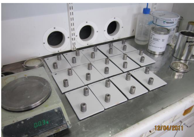
Kuva 8. Irtivetokokeen nuppien liimausta
