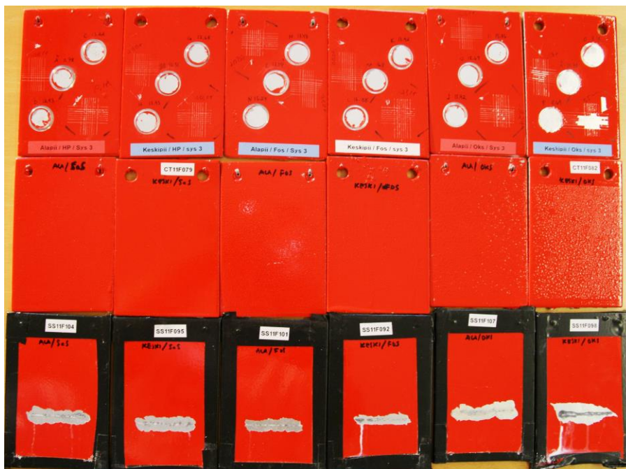
Kuva 3. Vesiohenteisella EPPUR-maalaujärjestelmällä maalattuja koelevyjä: Ylärivissä referenssilevyt, keskirivissä kondensaatiotestilevyt ja alarivissä suolasumutestilevyt. Vasemmalla SaS-käsiteltyjä ala- ja keskiin koelevyjä, keskellä Zn-fosfatoituja ala- ja keskiin koelevyjä ja oikealla silaanikäsiteltyjä ala- ja keskiin koelevyjä.
