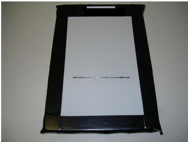
Kuva 6. Suolasumutestiin valmisteltu koelevy
