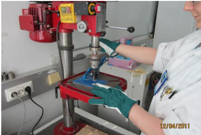
Kuva 9. Maalipinnan porausta pylväsporakoneella
