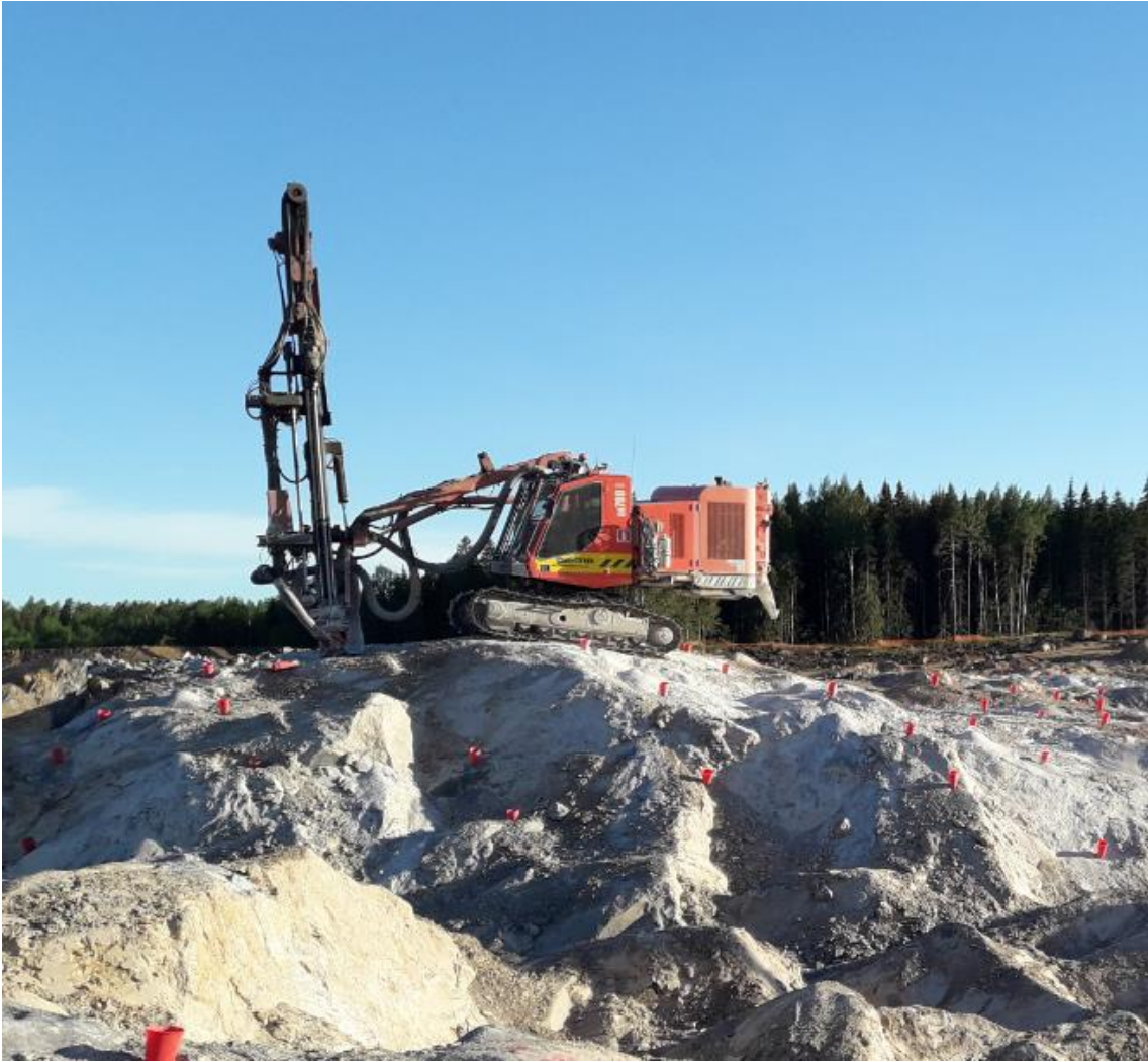
KUVA 6. Sandvikin valmistama keskiraskas poravaunu
