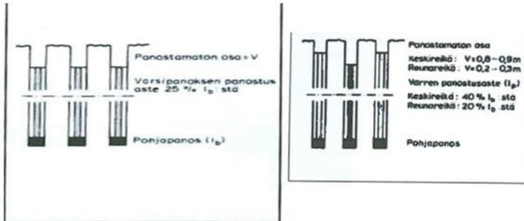
KUVA 2. Kanaalilouhinnan panostustavat (2, s. 155-156)
