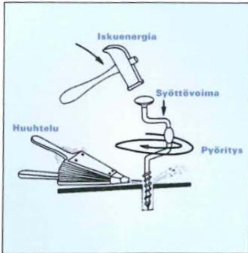
KUVA 5. Päältä lyövän porauksen idea (2, s. 130)
