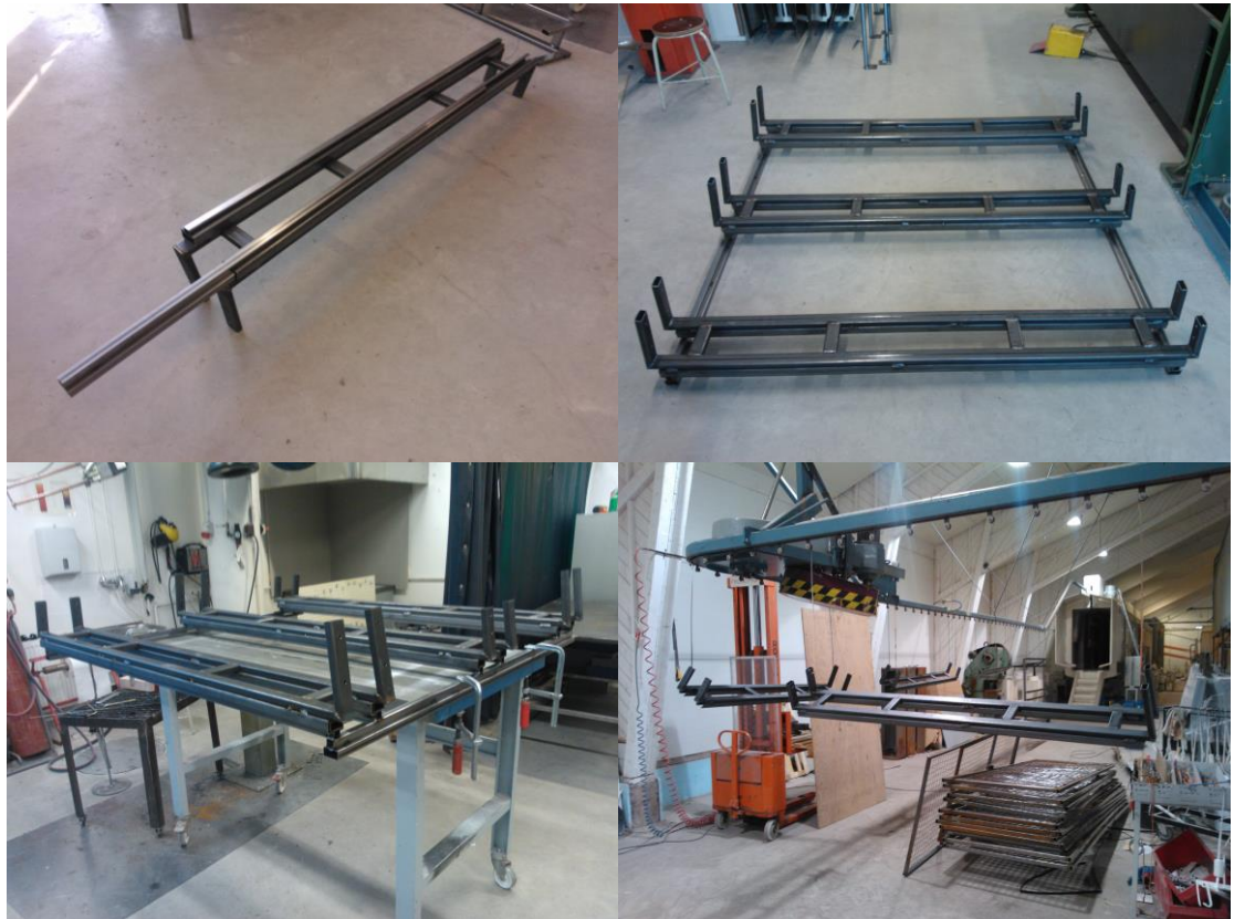
Kuva 31. Kiskojen sovitukselta kelkan kasaukseen. Lopuksi osat ripustettiin pulverimaalaamon maalauslinjalle.
