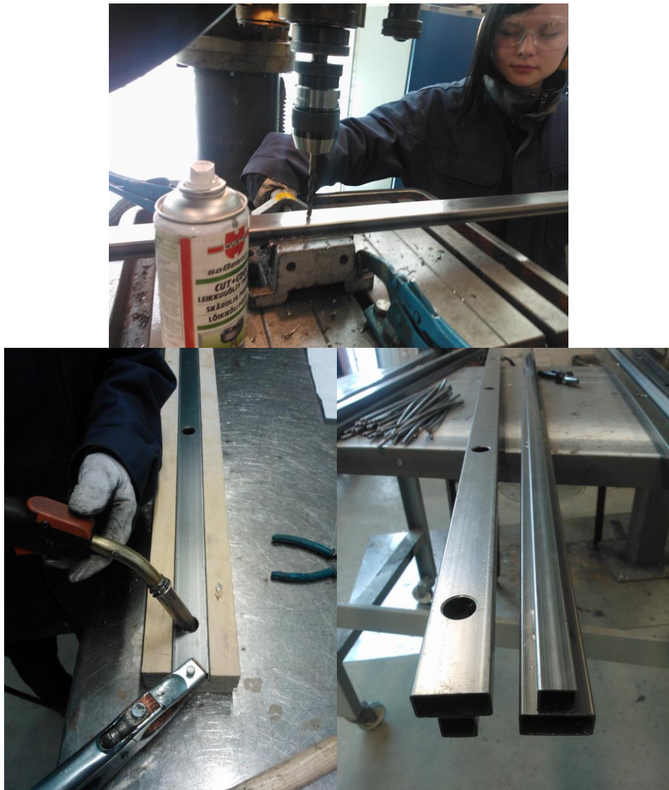
Kuva 30. T-profiilien valmistus kahdesta eri profiilista poraamalla ja hitsaamalla.
