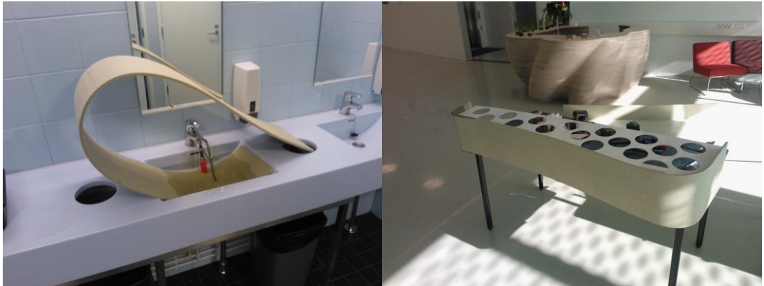
Kuva 27. Jyrityn MDF-levyn ”hydroformaus” tapahtui Kymenlaakson ammattikorkeakoulun Paja-rakennuksen wc-tiloissa. Aikaansaatu lopputulos on olosuhteisiin nähden oikein hyvä.
