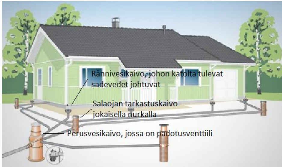
Kuva 4. Salaoja- ja sadevesijärjestelmä rakennuksen ympärillä. [7.]
