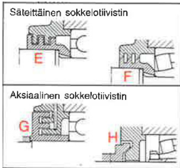
Kuva 8. Esimerkkejä kaksiosaisista säteittäisistä ja aksiaalisista sokkelorakenteista (Oy SKF Ab 1994, 88)
