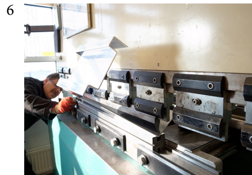
Ensiksi tein 3mm alumiinilevystä taivuttamalla hahmomallin, jonka päälle laitoin valkoista maalia.
