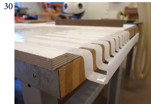
Muovi taittui helposti kuumentamalla. Tein laserilla myös aukot, jotta tuote voidaan kiinnittää ruuveilla seiniin. (kuva36)
