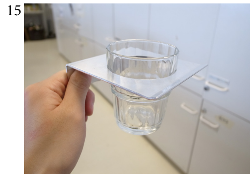
Tein porakoneella ja jyrsimellä aukot jokaiseen alumiinilevyyn.
