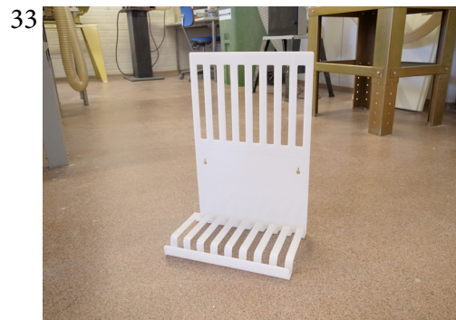
Muovi taittui helposti kuumentamalla. Tein laserilla myös aukot, jotta tuote voidaan kiinnittää ruuveilla seiniin. (kuva36)
