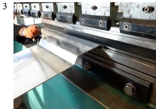
Ensiksi tein 3mm alumiinilevystä taivuttamalla hahmomallin, jonka päälle laitoin valkoista maalia.
