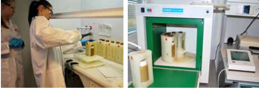
Liuetut ja laimennetut näytteet suljettiin keraamisiin astioihin, jotka laitettiin mikroaaltouuniin.
