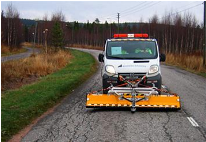
Kuvio 9. Maatutkausvälineistöä, mittausauto ja maavasteantenni (Roadex Implementing Accessibility 2001–2011c)
