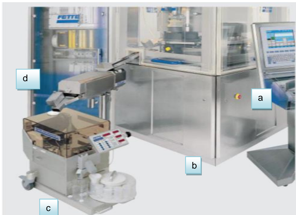
Kuva 9. Tabletin valmistuslaitteisto (a. ohjausyksikkö, b. tablettipuristin, c. CM 4.1 -laite ja d. virta ja serveriyksikkö) (Packaging-Processing).
