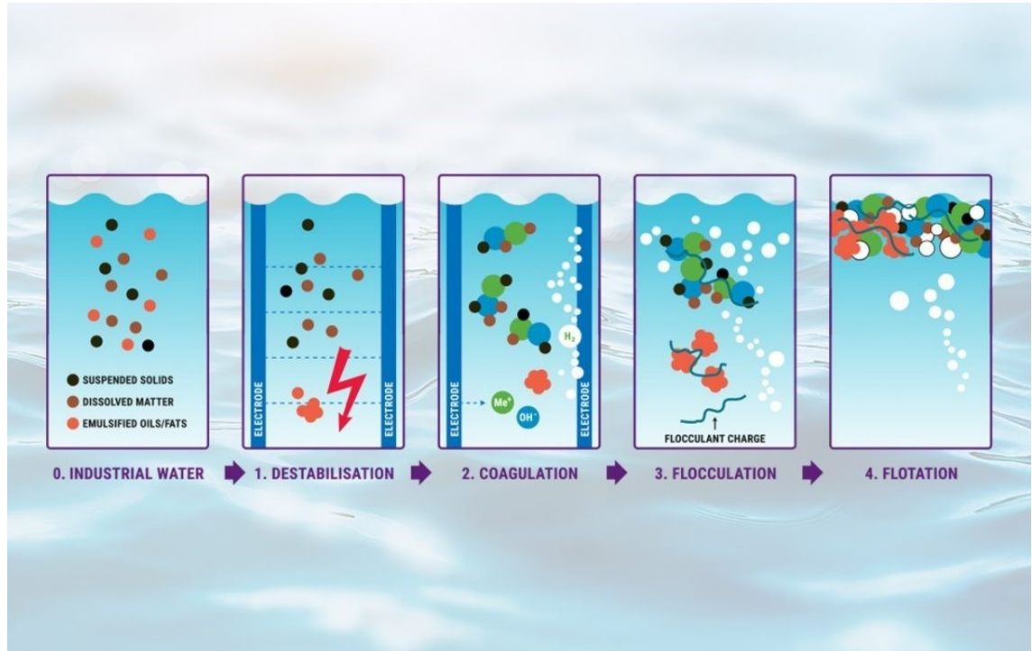
Kuva 4. Elektrokemiallisen kennon toiminta (Axolot Solutions 2018).
