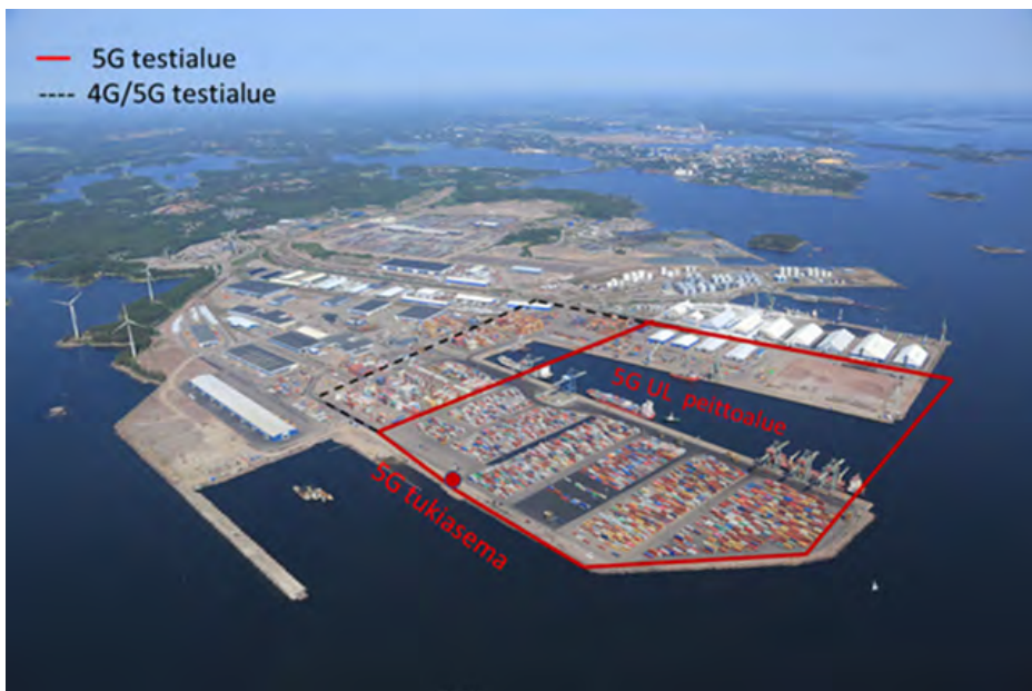
Kuva 2. 5G-testialue kartalla, jossa erilaisille 5G käyttötapauksille on määritetty alueet perustuen verkon suorituskykymittauksiin. Lähde: Muokattu HaminaKotka satama Oy:n kuvasta.
