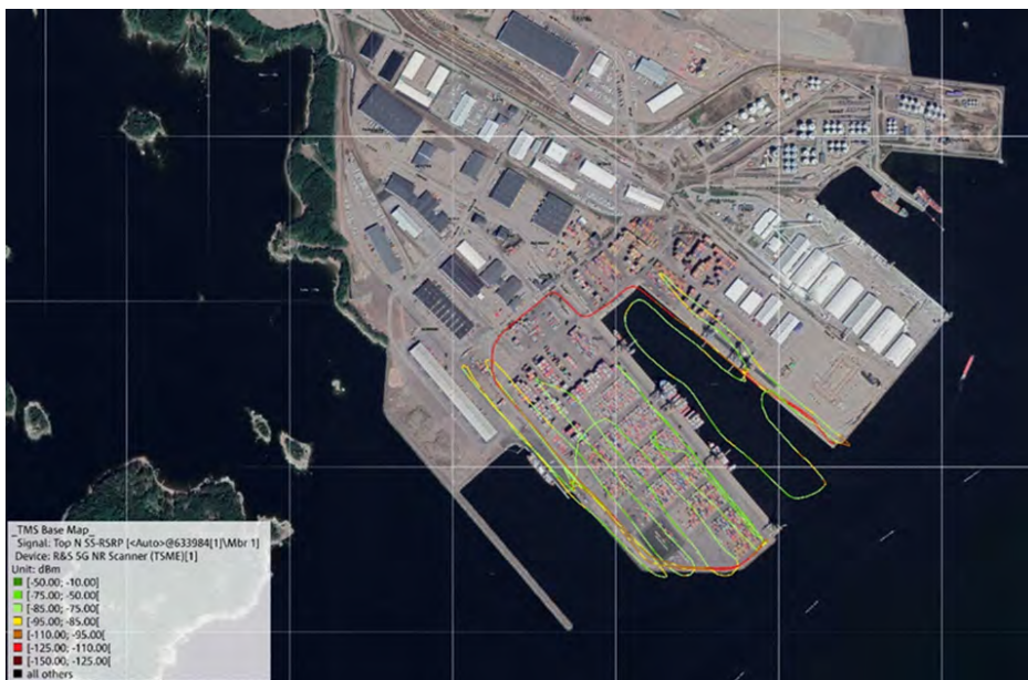
Kuva 4. Mussalon sataman 5G 3.5GHz -peittoaluekartoitus (SS-RSRP) 30 metrin korkeudella käyttäen dronea. Lähde: Romes4.
