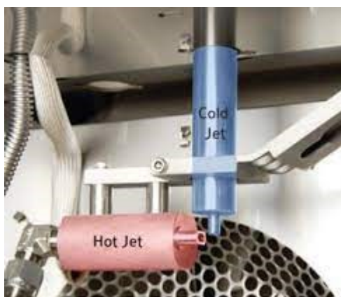
Kuva 6. Kryogeenisen modulaattorin toimintaperiaate. [13].
